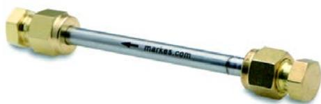
圖 1 3/4" x 1/4" 內部充填吸附劑的 TD 採樣管 (兩端並配有有黃銅製密封蓋)。此採樣管可適用於多種應用領域，包括對汽車車廂內空氣進行採樣，或對來自汽車內裝之飾件材料等之逸散物質來進行採樣
